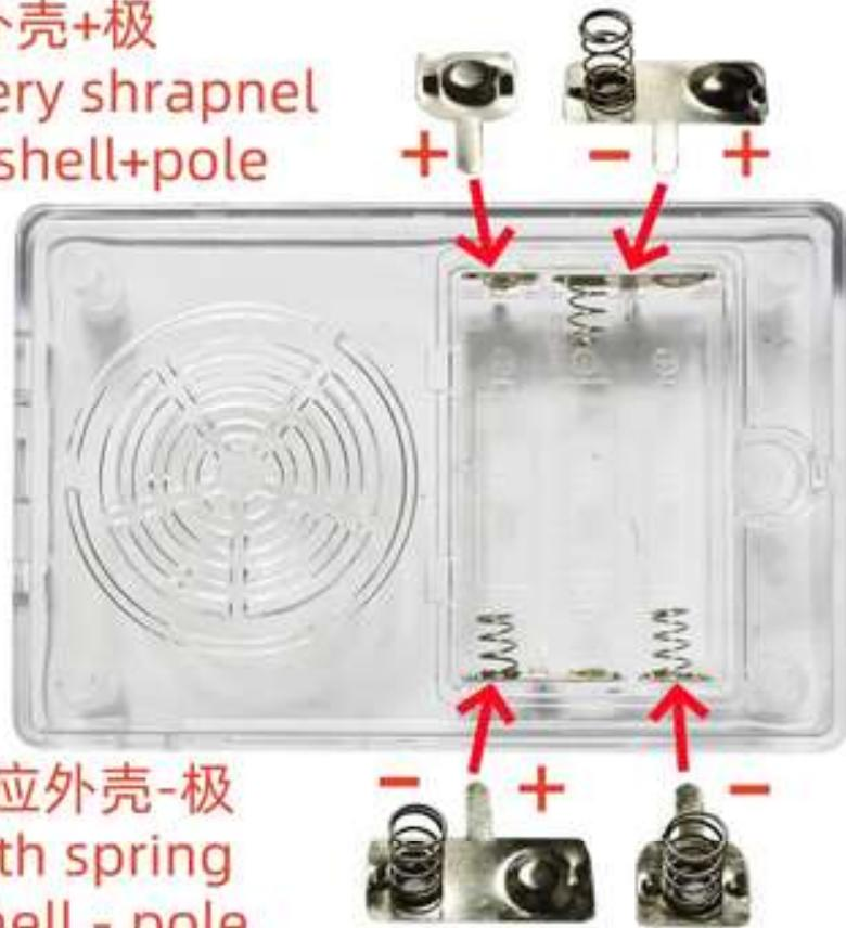
带有弹簧的电池弹片对应外壳-极
